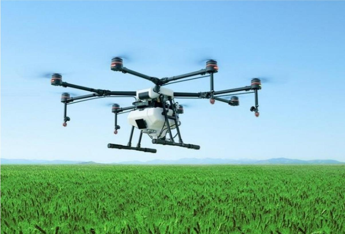
El fabricante chino ha presentado recientemente su primer dron destinado a tareas estrictamente agrícolas. Así es el DJI Agras MG-1, un multirótopero de 8 rotores diseñado para tareas de fumigación. Un paso más para DJI en el sector de los RPAS para uso profesional.
