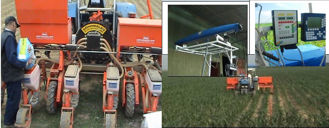
Şekil 3. Harita tabanlı uygulama ile kullanılan ve lineer aktüatörlerle uyarlanmış gübre serpme makinesi ve Sensör Tabanlı Azot Gübresinin Mısır Tarlasında Uygulanması (Türker ve Güçdemir, 2018).
