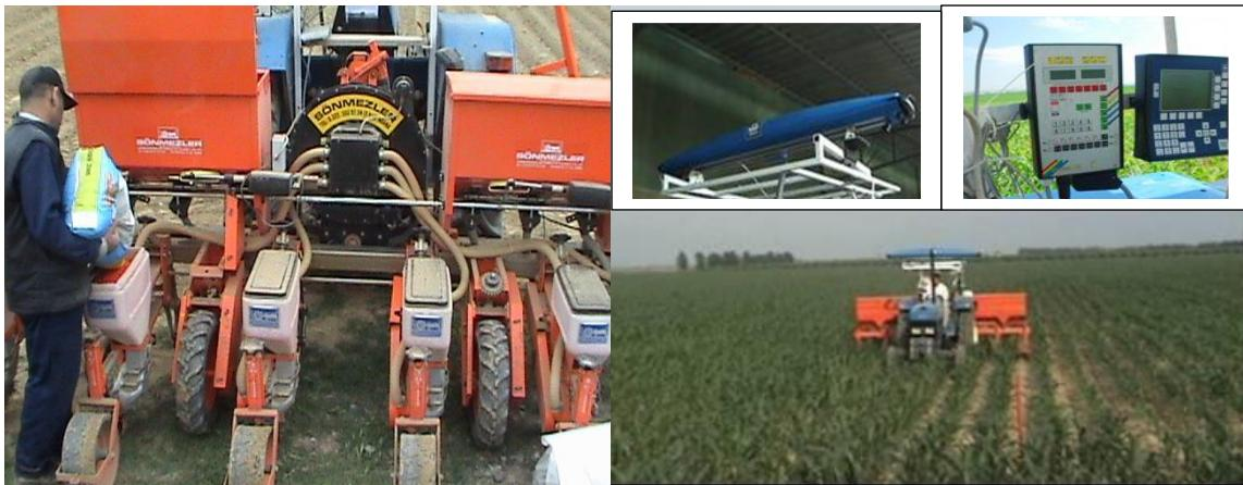
Slika 3. Rasipač đubriva koji se koristi sa primenom zasnovanom na karti i prilagođen linearnim aktuatorima i primenom azotnog đubriva zasnovanog na senzorima u polju kukuruza (Turker i Gucdemir, 2018).
