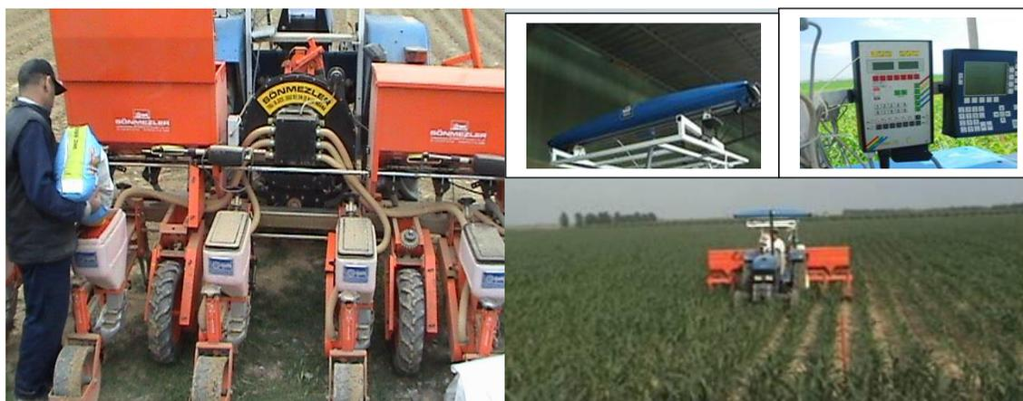
Figura 3. Esparcidor de fertilizante utilizado con aplicación basada en mapas y adaptado con actuadores lineales y aplicación de fertilizante nitrogenado basado en sensores en el campo de maíz (Türker y Güçdemir, 2018).
