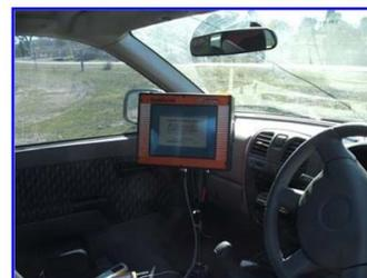
Figura 17. Sistema GPS RTK para medición de área de parcela montado en vehículo (Salem, 2007)
