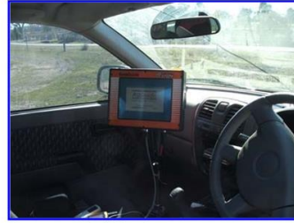
Εικόνα 8. Σύστημα RTK GPS που έχει τοποθετηθεί σε όχημα για τη μέτρηση του αγροτεμαχίου (Salem, 2007)
