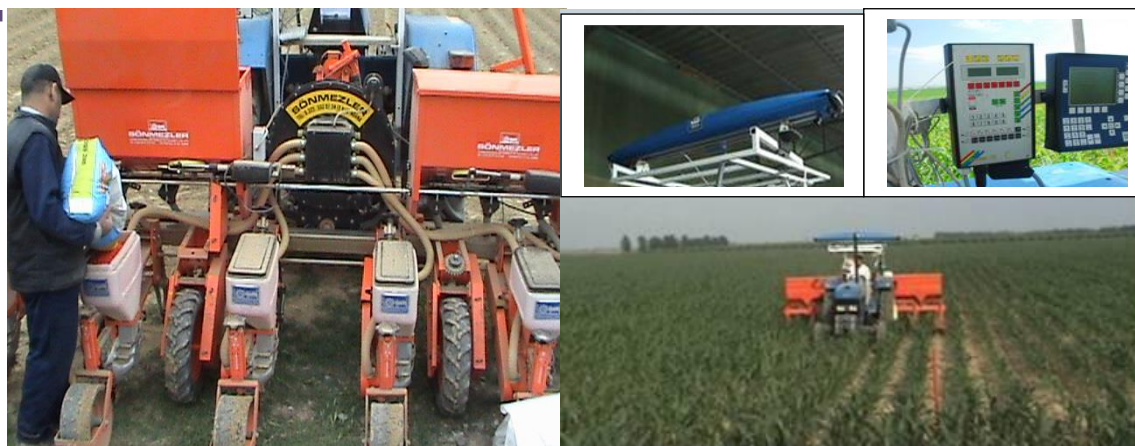
Εικόνα 1. Διανομέας λιπάσματος που λειτουργεί με εφαρμογή χαρτών και είναι προσαρμοσμένο με γραμμικούς ενεργοποιητές. Εφαρμογή αζωτούχων λιπασμάτων με αισθητήρα σε καλλιέργεια καλαμποκιού (Türker and Güçdemir, 2018).
